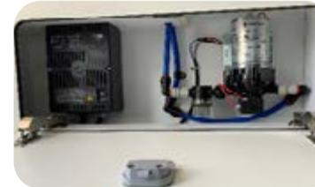
Die Pumpe wird über das Bedienfeld eingeschaltet (siehe Abbildung). Sie versorgt alle Wasseranschlüsse des Fahrzeugs und startet, wenn ein Hahn geöffnet wird.
