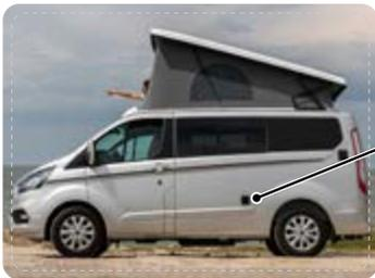
Zur Versorgung Ihres Fahrzeugs mit 230 V muss das Fahrzeug über eine genormte CEE-Kupplung an der linken Fahrzeugseite angeschlossen werden.
