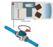
Válvula de vaciado de agua limpia
