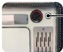
Regulador de la calefacción
